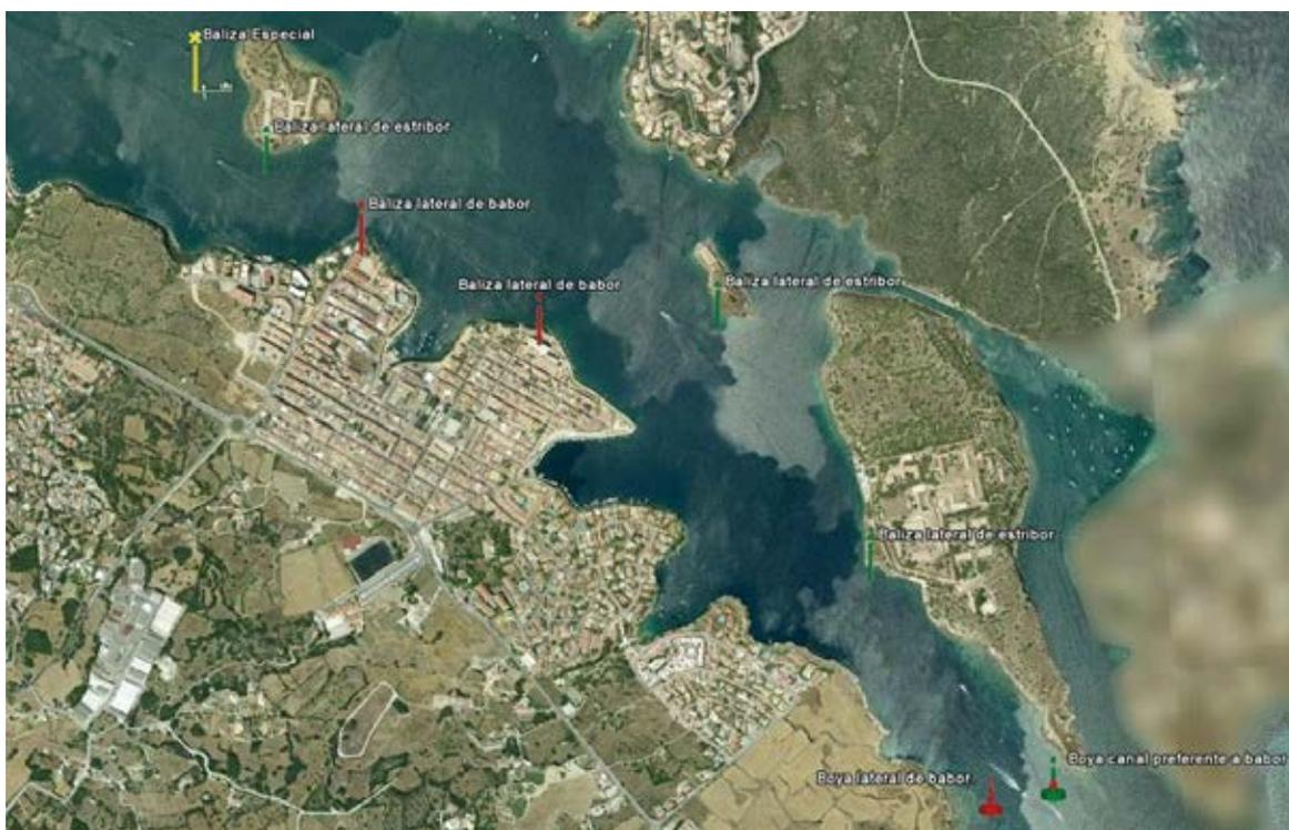
**Ilustración 74: Ejemplo de balizamiento. Mahón.**
