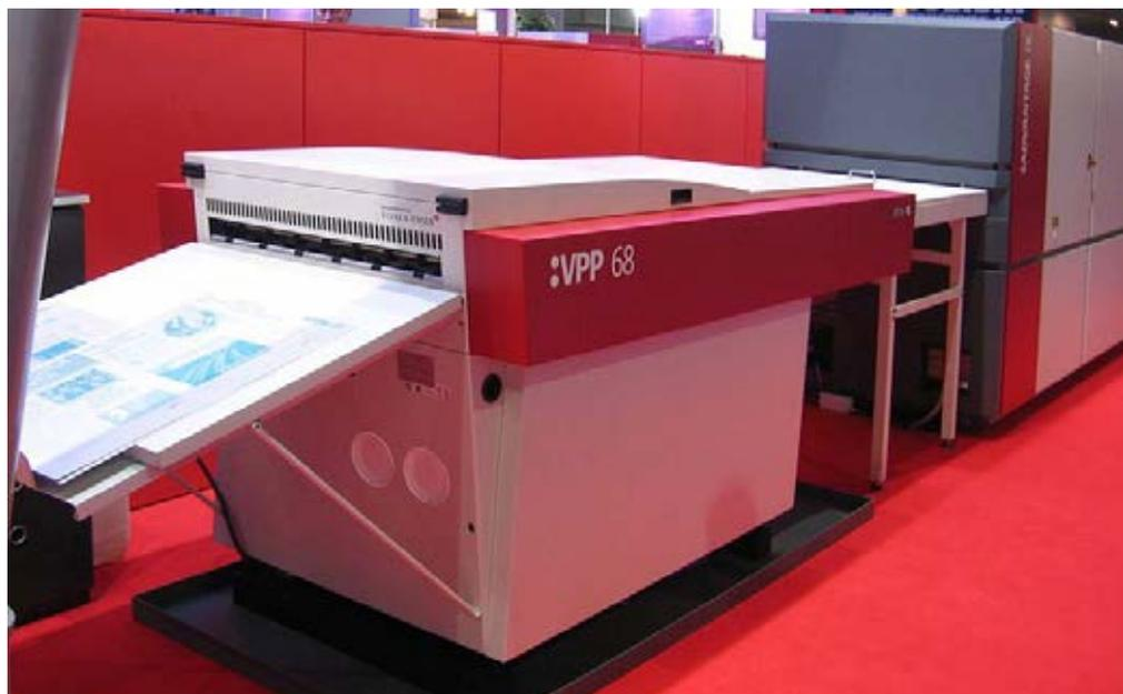
**Ilustración 105: Agfa VPP, sistema de impresión CTP directamente a la plancha.**
