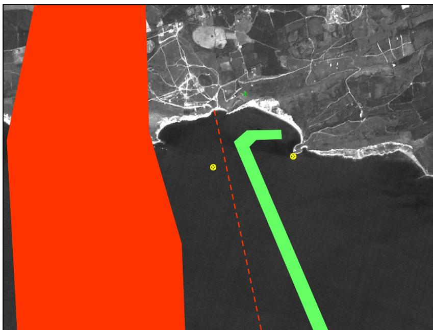
**Ilustración 42: AML sobre imagen satélite, mostrando naufragios, una tubería, zona a evitar y derrota a seguir.**
