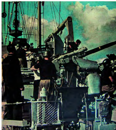
Un buque de la Marina alemana con un montaje doble de cañones antiaéreos de 3,7 cm, Rheinmetall Borsig. (Foto: revista Die Wehrmacht , vía Carlos Díez.)
