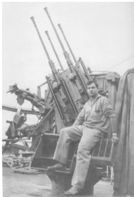
Antiaéreo cuádruple de 2 cm, denominado en su país de origen «Flakvierling». La foto fue tomada en el crucero Galicia en los años cincuenta. (Foto: José A. Fernández, vía A. Mortera.)
