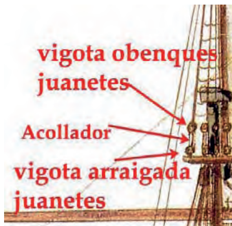
Para juzgar mejor las diferencias, recordemos la disposición previa de los obenques del mastelero de juanete mayor y de proa en nuestra marina, con vigotas, acolladores y arraigadas
