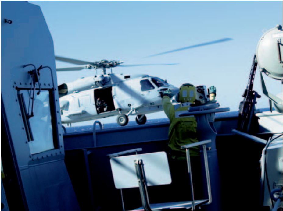
Fragata Méndez Núñez : maniobra de VERTREP en proa durante la calificación operativa el pasado mes de noviembre. El helicóptero ha de mantenerse en estacionario a la altura del puente mientras el barco sigue navegando. El LSE —que aparece en la foto— debe dirigir y observar constantemente las maniobras del piloto, pues el mínimo error tendría graves consecuencias. (Foto: Ó. Rodríguez Pardal).
