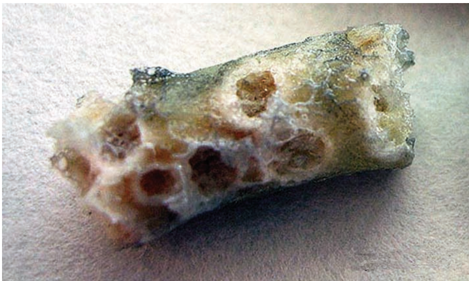
Grano de pólvora sin humo (nitrocelulosa) en los inicios de la descomposición espontánea.
