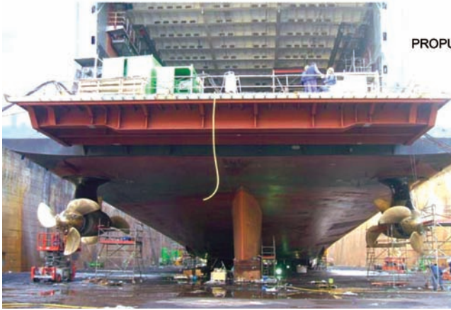
El LHD durante el montaje de las hélices.
