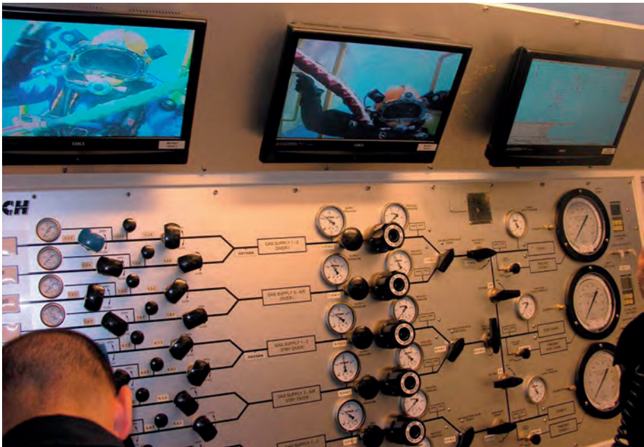
Cuadro de mezclas y pantallas del control de inmersiones.
