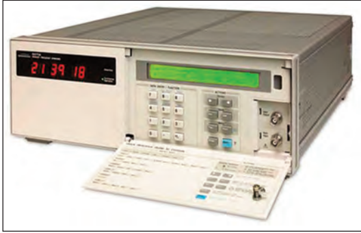
Patrón atómico de haz de cesio. El ROA cuenta en la actualidad con cinco de estos patrones y un máser de hidrógeno activo.
