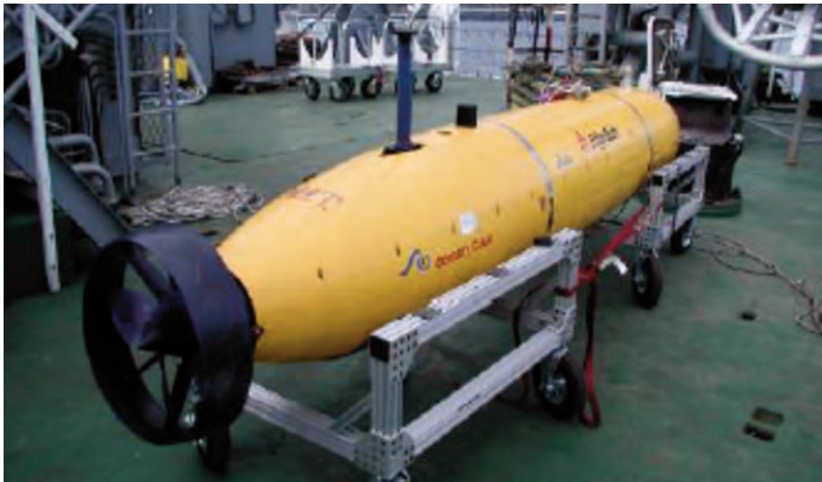
UUV integrado en un sistema multiestático, remolca una cadena de hidrófonos tipo TRIPLET como elemento pasivo del sistema.
