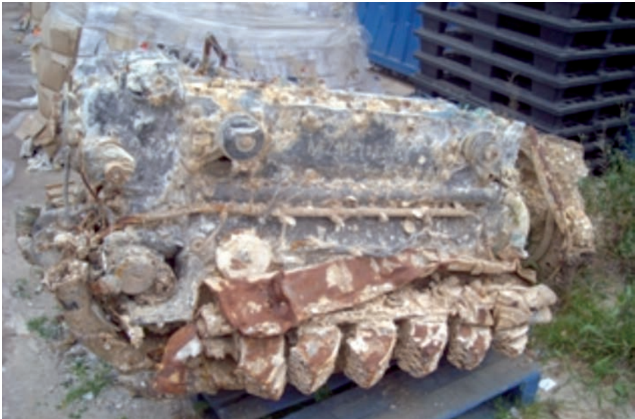
Los daños encajados por el motor Jumo 211F, recuperados por el pesquero Nuevo Pedro y Loli , quedan bien patentes a través de esta imagen. (Foto: José Miguel Sales Lluch).
