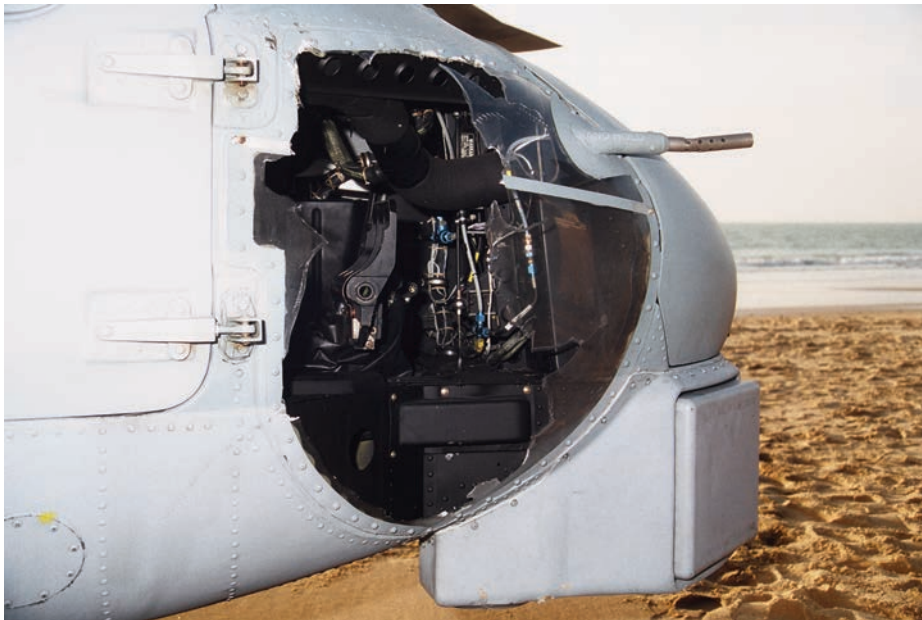
Daños producidos en el morro por el accidente del SH-60B con toma en la playa de Chipiona. (Foto proporcionada por P. O. B.).
