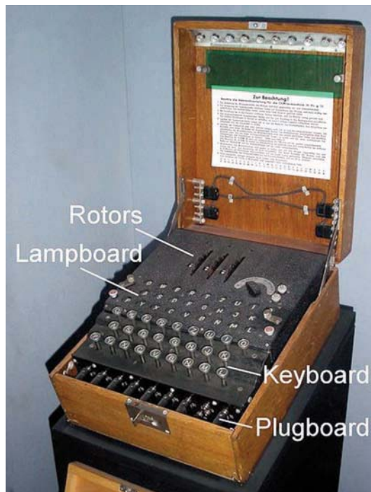
Enigma de tres rotores. (Foto: www.wikipedia.org ).
