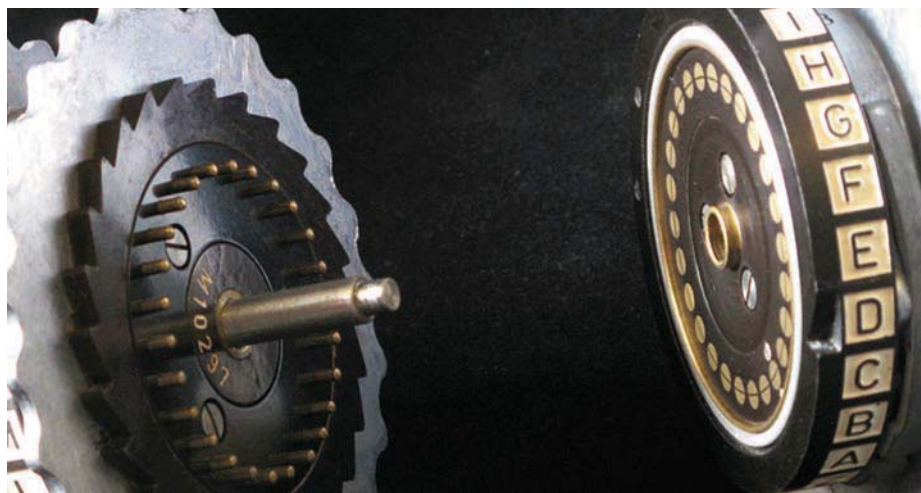
Rotores mostrando los conectores de uno y otro lado, y el Ringstellung a la derecha. (Foto: www.wikipedia.org ).
