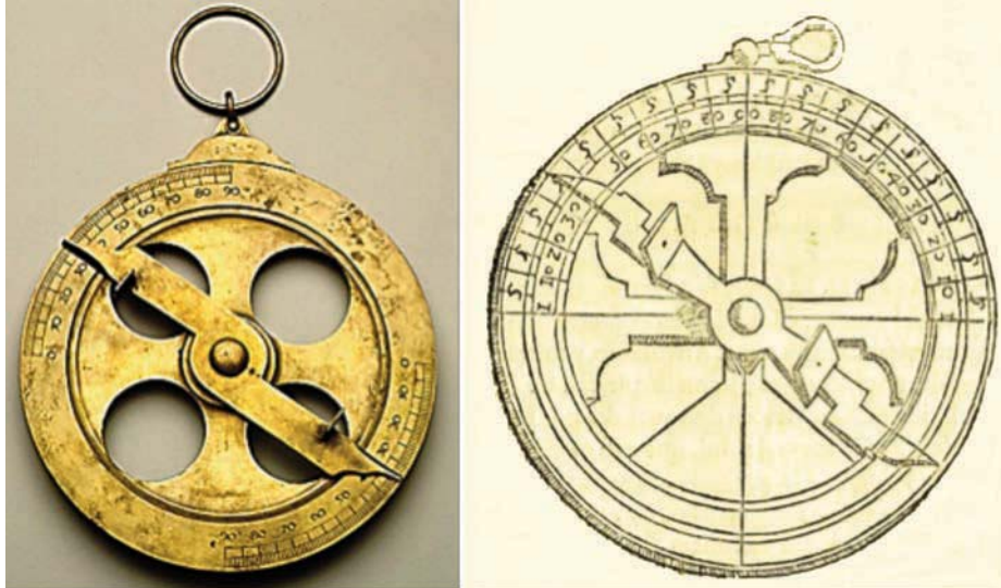
Astrolabio náutico y figura extraída del tratado de Instrucción náutica para navegar , de Diego García de Palacio, 1595. (Museo Naval Madrid, MNM- 290).
