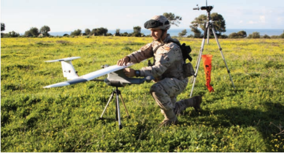
Preparación para lanzamiento de RPAS Clase I Mini Alcotán del TEAR. (Fuente: ORP TEAR).
