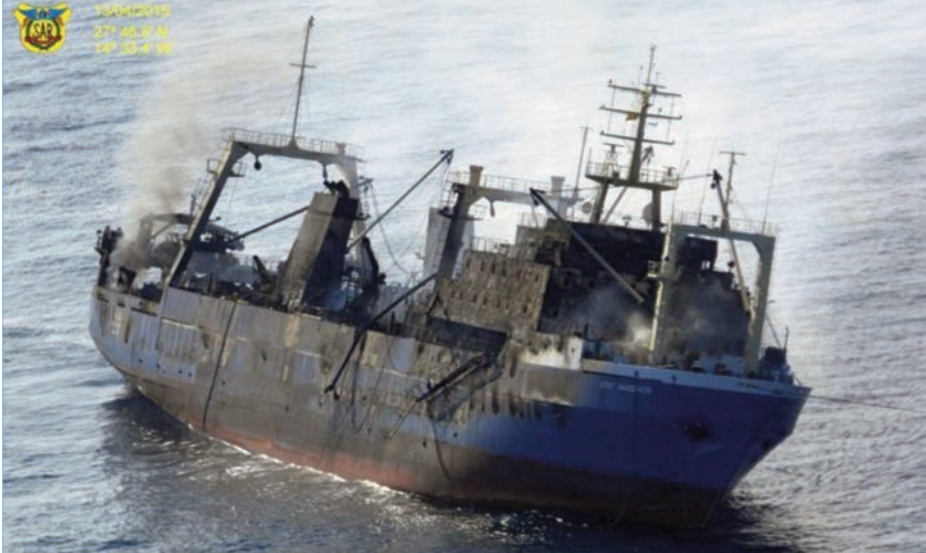
El Oleg con el incendio casi extinguido y una fuerte escora a babor. (Foto: Escuadrón SAR vía El Mundo ).
