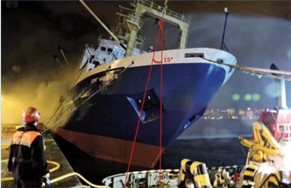
Se inicia el remolque a las 03:52 h con un incendio sin controlar y 15° de escora. (Foto: CIAIM).
