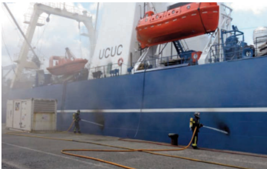
Líneas de refresco en la zona de proa de la cámara de máquinas. (Foto: CIAIM).
