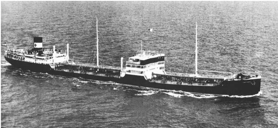
En esta imagen del Campoamor se aprecian las dimensiones y la disposición general de los petroleros grandes de CAMPSA. ( Revista Ingeniería Naval ).
