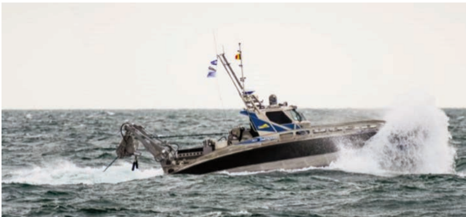
Seagull durante Belgian North Sea MCM Trials 2017 . Buque teledirigido remolcando un sonar de barrido lateral. (Fuente: Elvit Systems. Internet).
