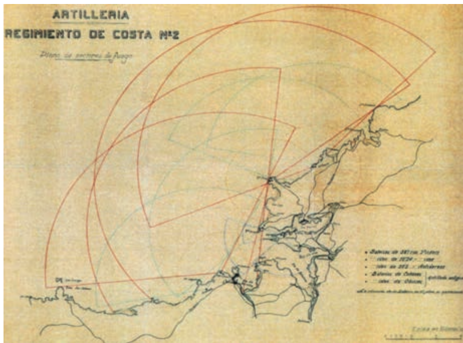
Sectores de fuego y alcances de las baterías de costa emplazadas en el Arco Ártabro.
