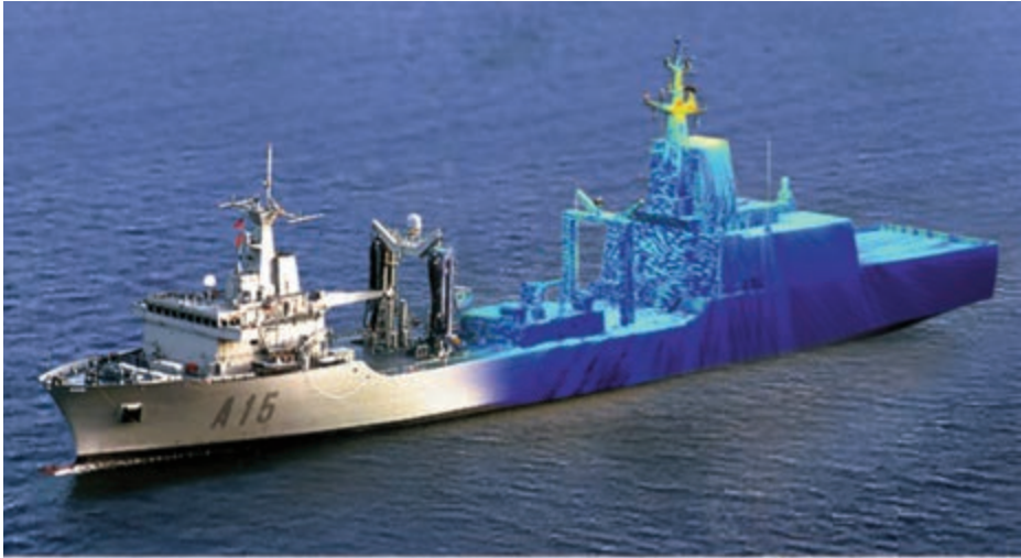
Buque Cantabria con una representación parcial de corrientes inducidas sobre su superficie obtenida con el código de simulación electromagnética M3.
