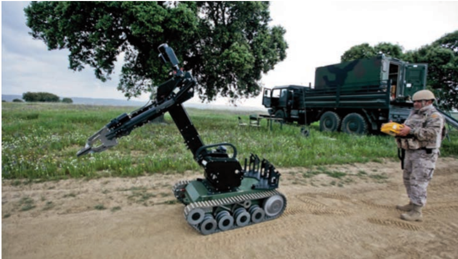
Figura 7. Robot de desactivación de explosivos Theodor . (Foto: Jorge Valdés Rodríguez).
