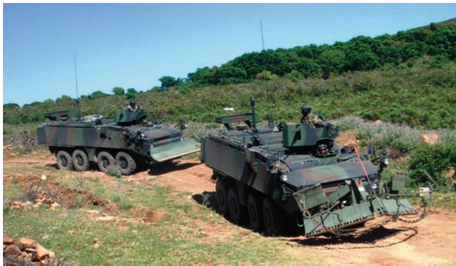
Figura 2. Vehículos de combate de zapadores Piraña III , con implemento de arado antiminas y pala empujadora. (Foto: Armada española).
