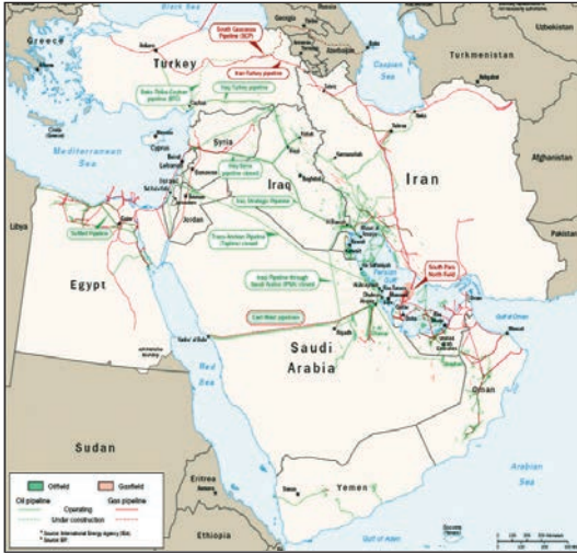
Oleoductos en el golfo Pérsico. (Energy Information Administration).
