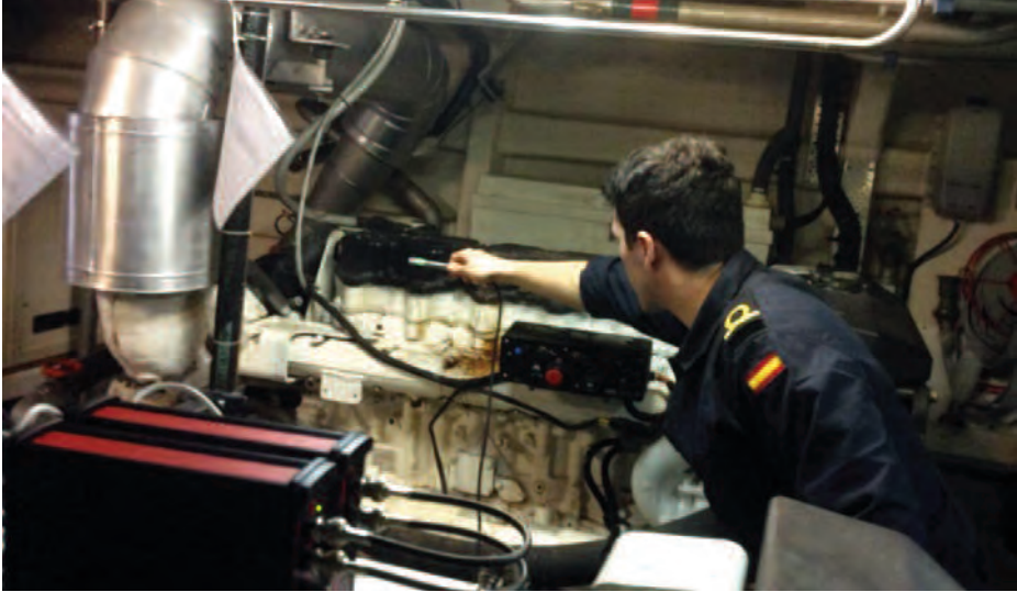
Empleo de la sonda del equipo de acústica avanzada durante la evaluación de radiación sonora del motor de una lancha de instrucción. (Fuente: Armada).
