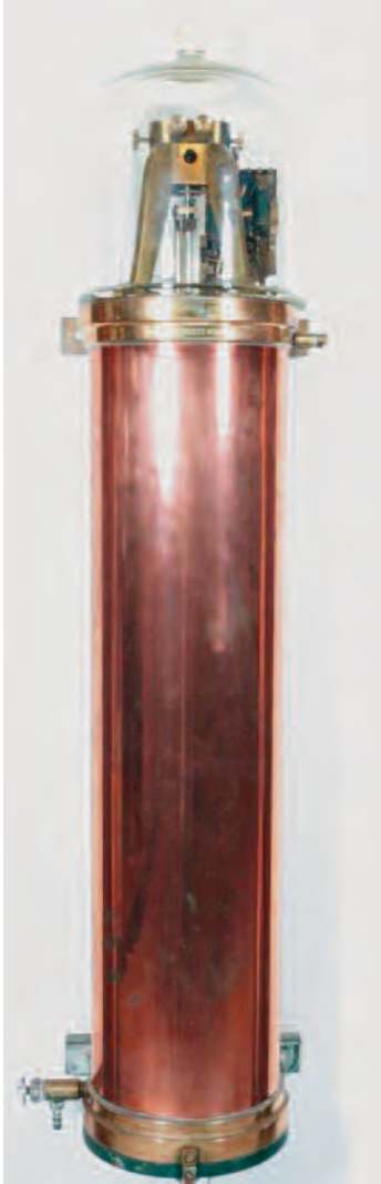
Figura 2. Péndulo Shortt a presión y temperatura constante (1935).
