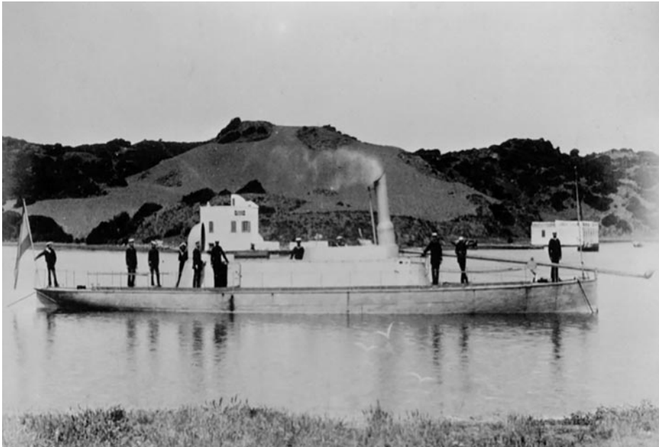
Torpedero de botalón Cástor (1878), con el botalón lanzatorpedos en proa. Mahón. (Foto: Archivo Museo Naval)
