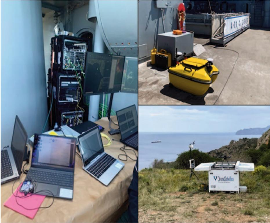
A la izquierda, nodo 5G a bordo del *Contramaestre Casado*. Arriba a la derecha, USV en cubierta, y debajo, «nido» de UAV en La Algameca. (Fotografías facilitadas por el autor)
