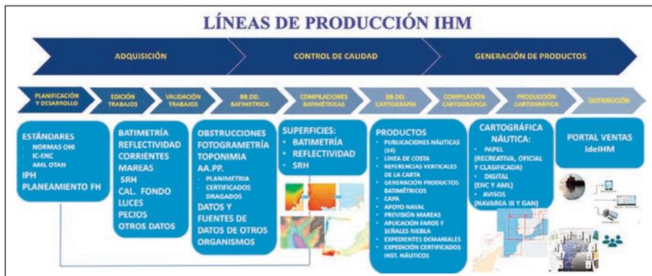
Figura 2. Flujo de trabajo de la producción cartográfica.
