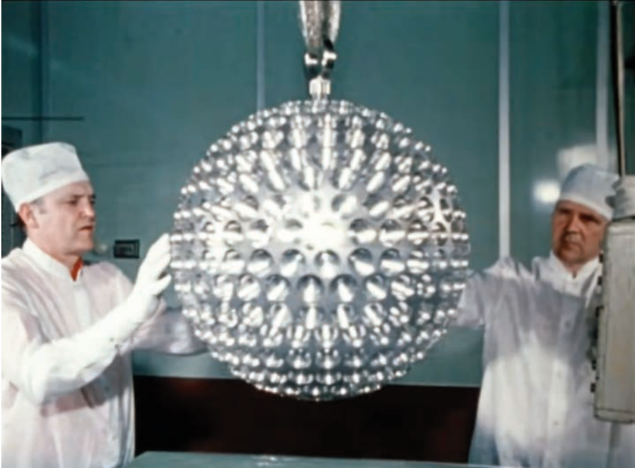
Figura 5. Satélite LAGEOS-1 antes de su lanzamiento en 1976. Destaca su pequeño diámetro (60 cm) y la presencia de 426 retroreflectores alrededor de toda su superficie para su empleo con técnicas de telemetría láser. (Fuente: NASA)
