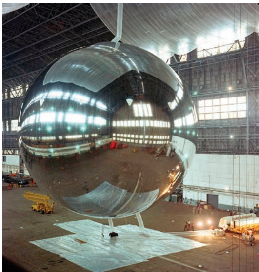
Figura 2. El satélite PAGEOS en una prueba de inflado realizada en 1965 en un hangar de dirigibles en Weeksville, Carolina del Norte. Se pueden observar su gran tamaño (30 m de diámetro) y las propiedades reflectantes de su superficie aluminizada. (Fuente: NOAA)
