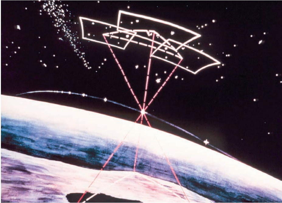
Figura 1. Triangulación mediante la observación de un mismo satélite artificial desde tres estaciones base diferentes. Desde cada punto se observa el satélite sobre una región distinta del fondo de estrellas. Conocidas las coordenadas geográficas de dos estaciones base, se puede determinar la ubicación de la tercera por métodos geométricos. (Fuente: NOAA)
