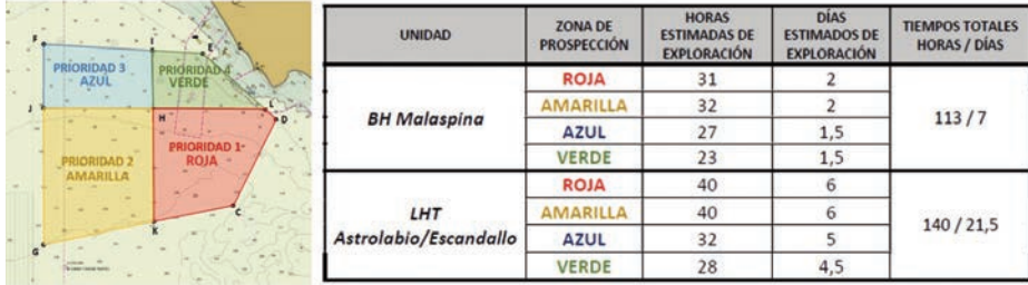
Figura 11. Zonas de prospección del AIB, con orden de prioridad de ejecución y tiempos estimados de exploración aproximados con ecosonda multihaz.
