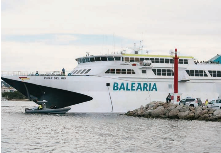
El 8 de junio de 2018 el catamarán (ro-pax) Pinar del Río fue abatiendo hasta embarrancar con el patín de babor en una roca de la escollera del puerto de San Antonio de Portmany. (Fotografía facilitada por el autor)
