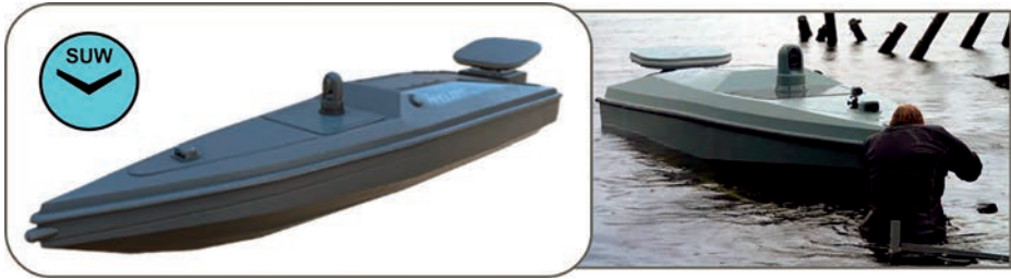
Figura 9. USV suicida Magura V5. (Fuente: Spets Techno Export)
