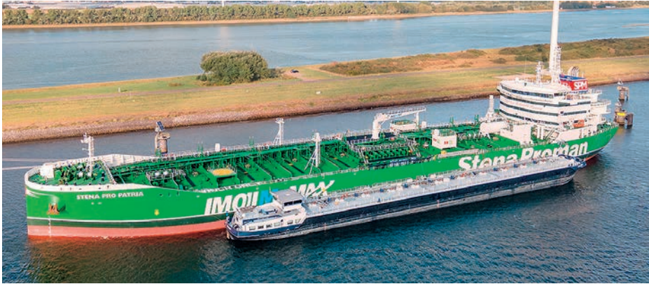
Quimiquero Stena Pro Patria , buque a metanol de combustible dual. (Fuente: Det Norske Veritas, DNV)
