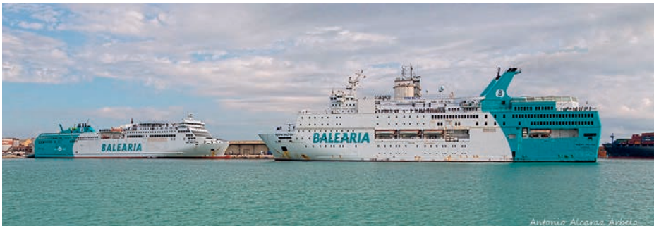
La empresa Baleària en España apuesta por buques duales propulsados por LNG y gasoil marino. (Fuente: Harbour Pilot )
