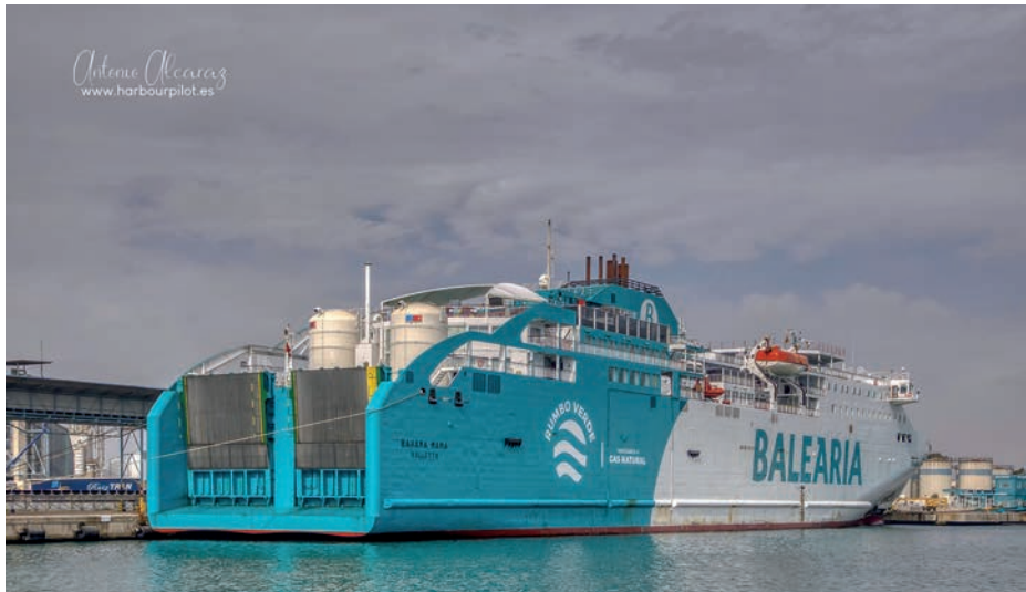
Buque de Baleària de propulsión dual con LNG y fueloil. (Fuente: Harbour Pilot )
