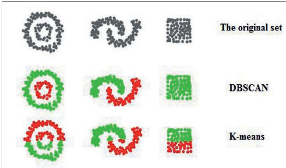
Figura 3. Una comparación esquemática de la naturaleza de los clústeres formados por los algoritmos DBSCAN y K-means. (Fuente: MOCHURAD, L., et al. , 2023) (9)
