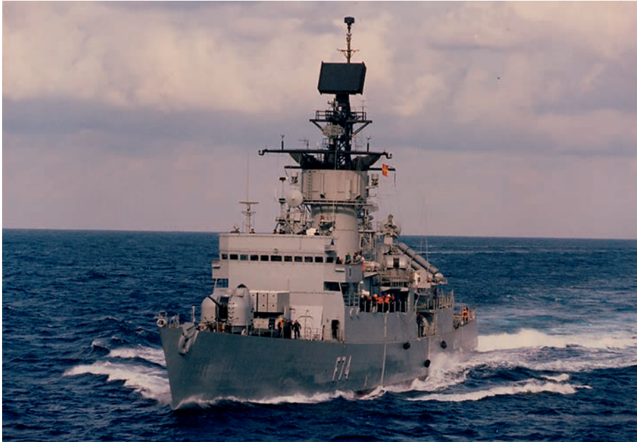
Fragata Asturias (F-74). Antena del radar AN/SPS-52. (Foto: Armada)
