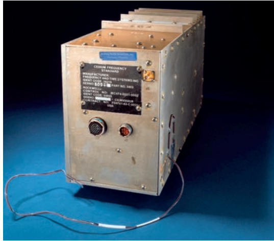
Reloj atómico de Cesio construido para los primeros satélites GPS a finales de 1970. (Foto: www.wikipedia.org )
