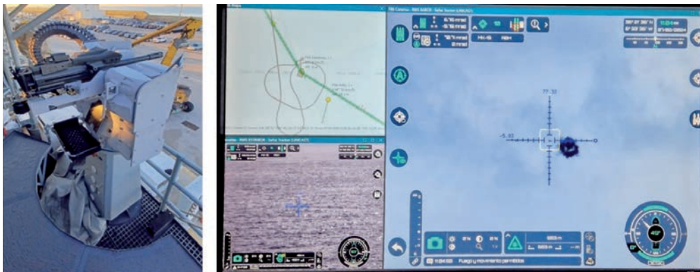
Lanzagranadas MK-19 montado sobre la RWS en el alerón de babor de la Numancia , y derribo de un UAV comercial durante las pruebas a bordo de la fragata Canarias . (Imágenes proporcionadas por del autor)
