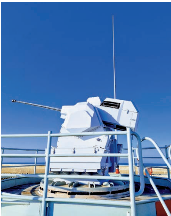
Montaje Sentinel 30 instalado en la plataforma del Meroka a popa de la cubierta 2 de la fragata Santa María . (Fotografía del autor)
