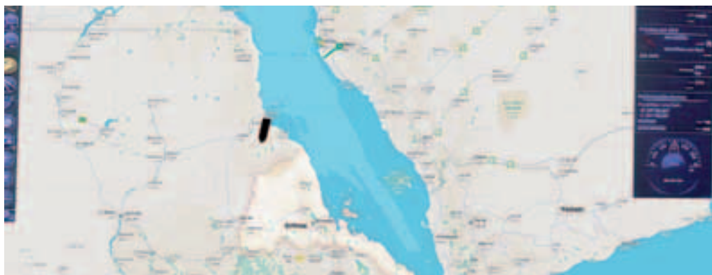
Un spoofing en la zona del mar Rojo. Puede observarse cómo el barco aparece sobre tierra. (Imagen facilitada por el autor)
