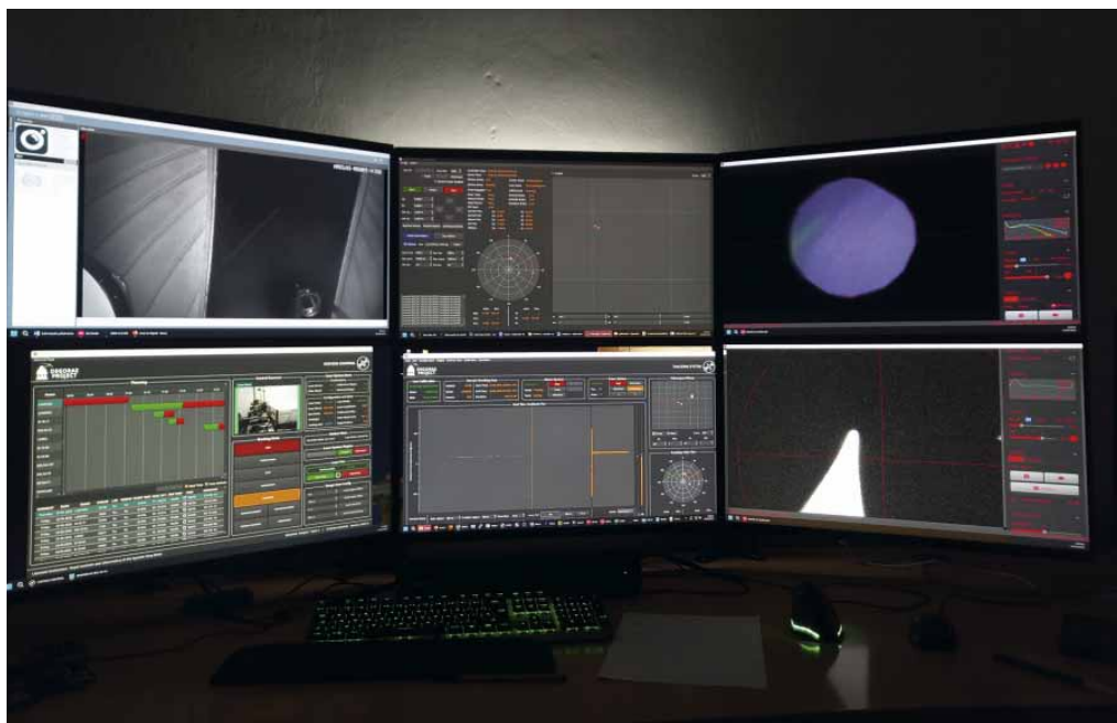
Figura 8. Nuevo puesto de control de la estación SFEL durante un seguimiento. Se puede observar parte del software de control desarrollado por los ingenieros de la estación, así como la emisión de los pulsos láser en las cámaras astronómicas. (Fuente: ROA)
