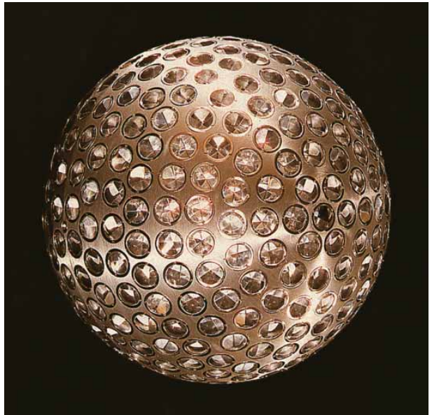
Figura 3. Imagen del satélite geodésico LAGEOS-1. Se puede observar su superficie esférica de 60 cm de diámetro recubierta de retrorreflectores. (Fuente: NASA)
