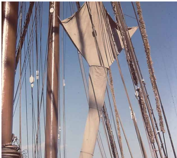
Pacífico. Manguerote para ventilación de interiores. (Imagen facilitada por el autor)
