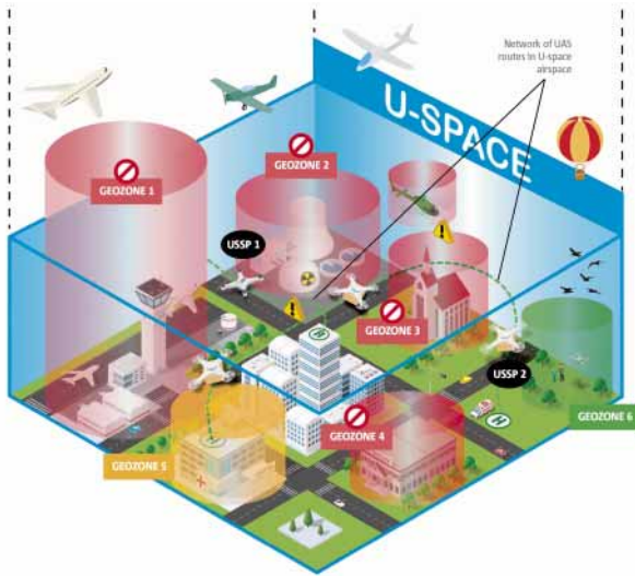
Funcionamiento del U-Space. (Imagen facilitada por el autor)
