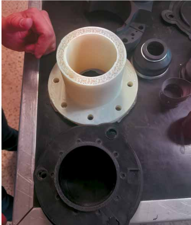
Elemento generado en las instalaciones del Ejército de Tierra en Zaragoza, relleno con resina epoxi para dar resistencia. (Imagen facilitada por el autor)
