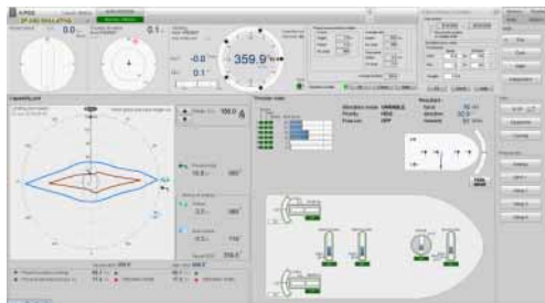
Captura de pantalla de la consola de operador del sistema DP2. (Imagen facilitada por los autores)
