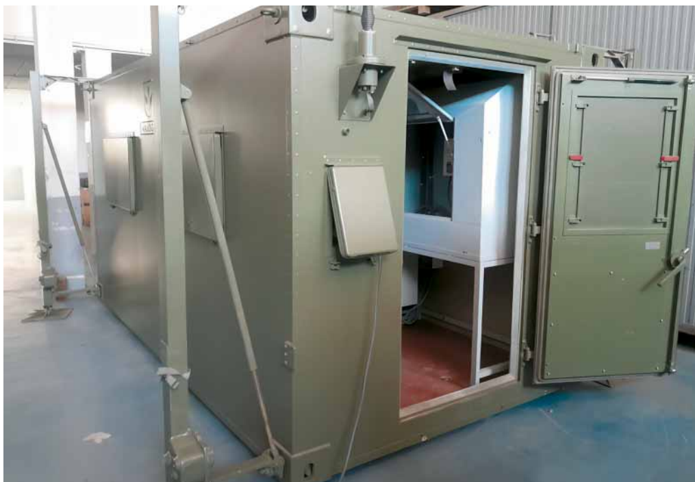
Módulo de impresión 3D del Ejército de Tierra enviado a la zona de operaciones. Contenedor Prometeo. (Imagen facilitada por el autor)
