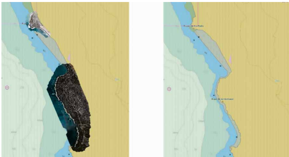
Integración de la nueva línea de costa y de la ortofotografía generada con RPAS en la carta náutica electrónica del IHM. (Fuente: IHM)
