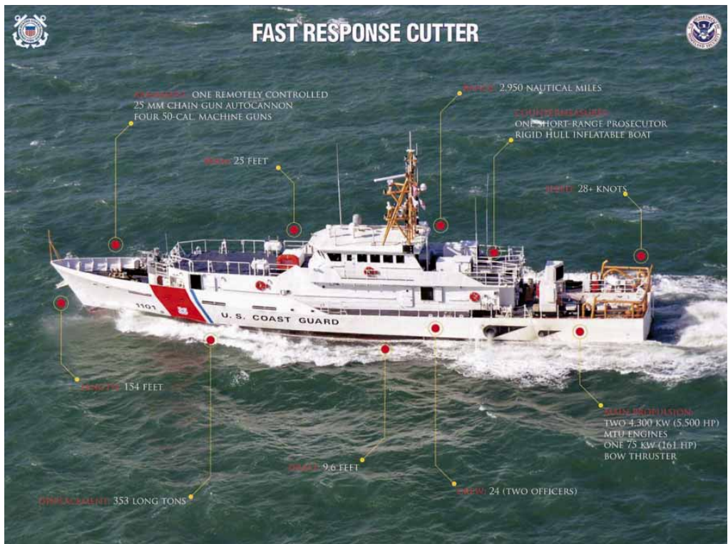
Diagrama explicativo de la clase Sentinel . (Fuente: www.uscg.mil )
