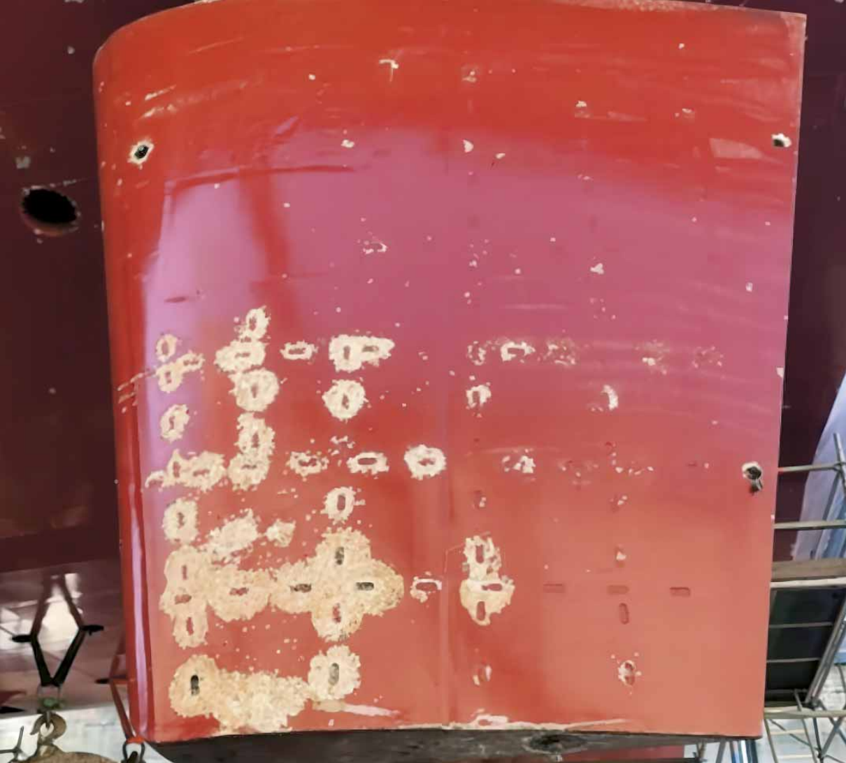
Ilustración 3. Detalle de los timones tras la limpieza (F-101). (Fotografía facilitada por los autores)
